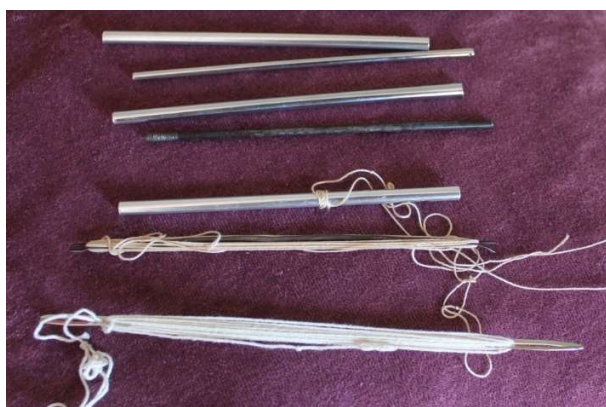
“Agulha” ou lançadeira, carregada com fio de algodão e “Ferrinhos” ou moldes, reaproveitamento de uma antena
